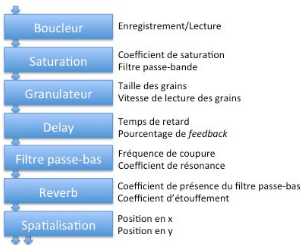
Figure 4 : Chaîne audio de TouchVoices
